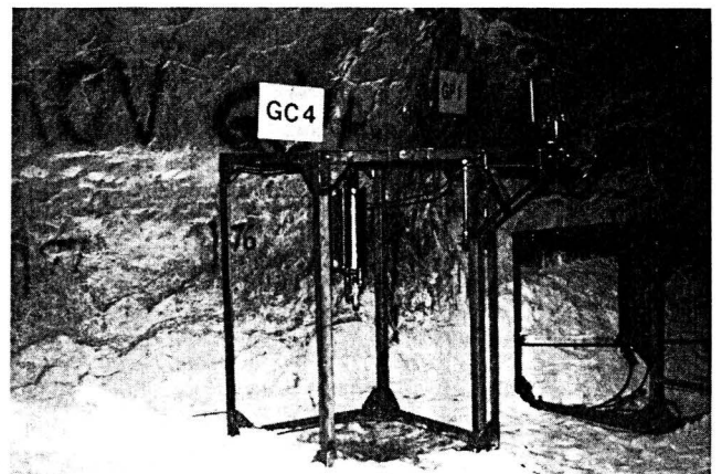
Bild 1. Geochemie-Meßstation im Kalibergwerk Hope auf der 724-m-Sohle zur Beobachtung der Lösungsentwicklung während und nach der Flutung.
